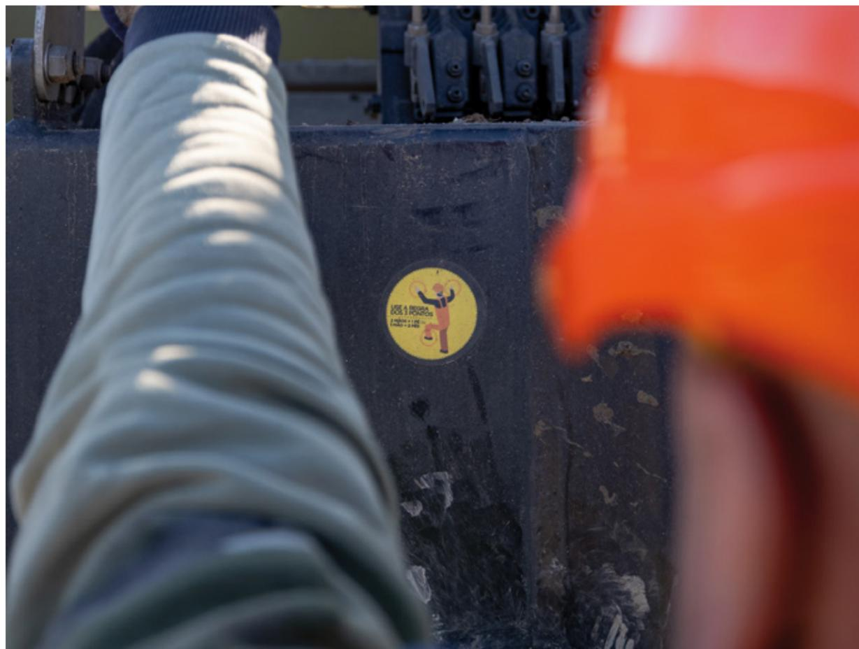
▲ A Madeicampo colou um autocolante em cada local “crítico” de subida e descida, para recordar aos motoristas e tratoristas a regra dos três pontos de apoio.
